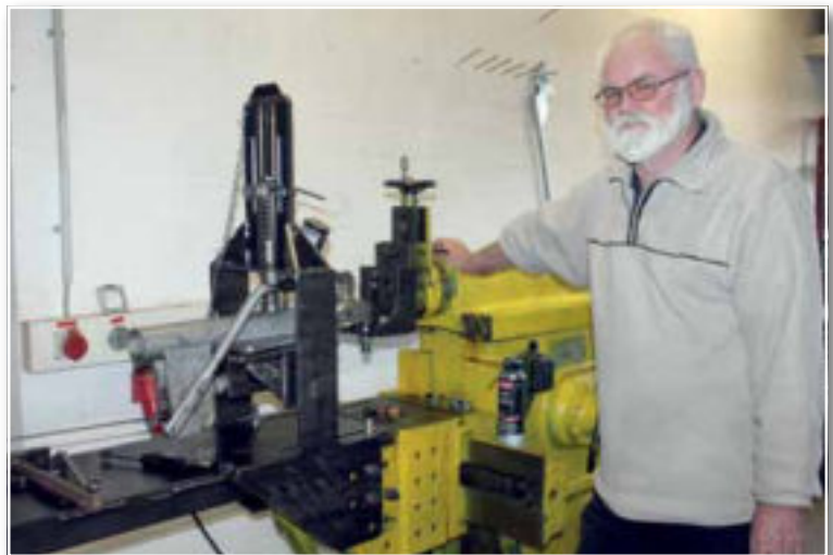
Verkaufsleiter Heiko Däbritz mit dem Führungsrohr einer bei Tegeder in Obergoseln überholten Auflaufeinrichtung für den guten, alten DDR-Anhänger HP 700. Bild rechts: Wolfram Nicolai beim Prüfen einer Auflaufeinrichtung. Beim Dauerlastversuch werden hier zwei Millionen Lastwechsel für 2.400 Kilogramm Gesamtgewicht simuliert. Das dauert, muss aber sein, denn die Sicherheit der neuen Auflaufeinrichtungen hat Priorität.
