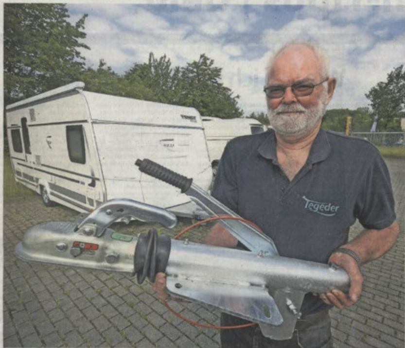
Wolfram Nicolai zeigt die Auflaufeinrichtung, die er gemeinsam mit Stefan Schneider entwickelt hat. Sie zeichnet sich durch einen längeren Auflaufweg aus, wodurch das Blockieren von Bremsen verhindert wird.
